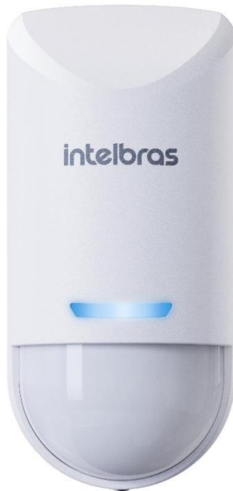
El sensor de movimiento IVP 5000 MW LD combina la detección por microondas con la detección por infrarrojos pasivos, adoptando tecnología avanzada de análisis de señales para evitar disparos accidentales. Desarrollado con un sensor PIR QUAD y lente Fresnel semiesférica, aumenta la eficiencia de la detección de movimiento y reduce las áreas no detectadas debajo del sensor.
